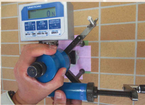
④ 引張試験器テクノスター-RJ-1にて目地モルタル強度確認試験を行う
